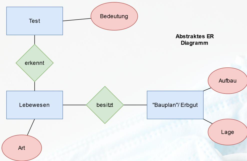
In der Informatik werden diese Diagramme auf einem abstrakten Level dargestellt, um sie als Schablone für unterschiedlichste Anwendungen einzusetzen. Im Beispiel links siehst du, wie man ein konkretes Diagramm auf einem abstrakten Level darstellen kann.
